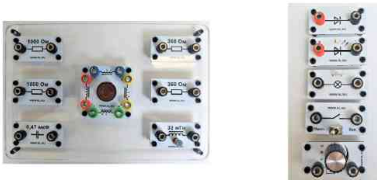
Рис. 17. Дополнительные элементы электрических цепей
